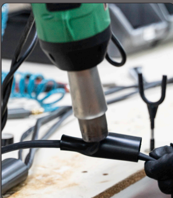
Главный признак правильной усадки — небольшое выступание излишков клея по обоим краям трубки после её остывания.
