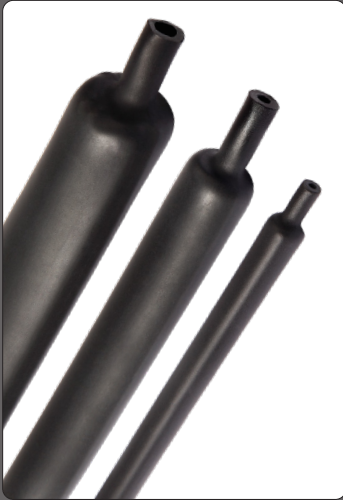
Высокий коэффициент усадки 3:1 позволяет изолировать соединения с большим перепадом диаметров.
